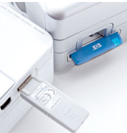
▲ Bluetooth-liitäntä helpottaa kuvien suoratulostusta esimerkiksi kamerapuhelimesta. Sonyn bluetooth-sovitin liitetään usb-porttiin. HP:ssä sinihammas valtaa tulostimen compact flash -korttipaikan.
